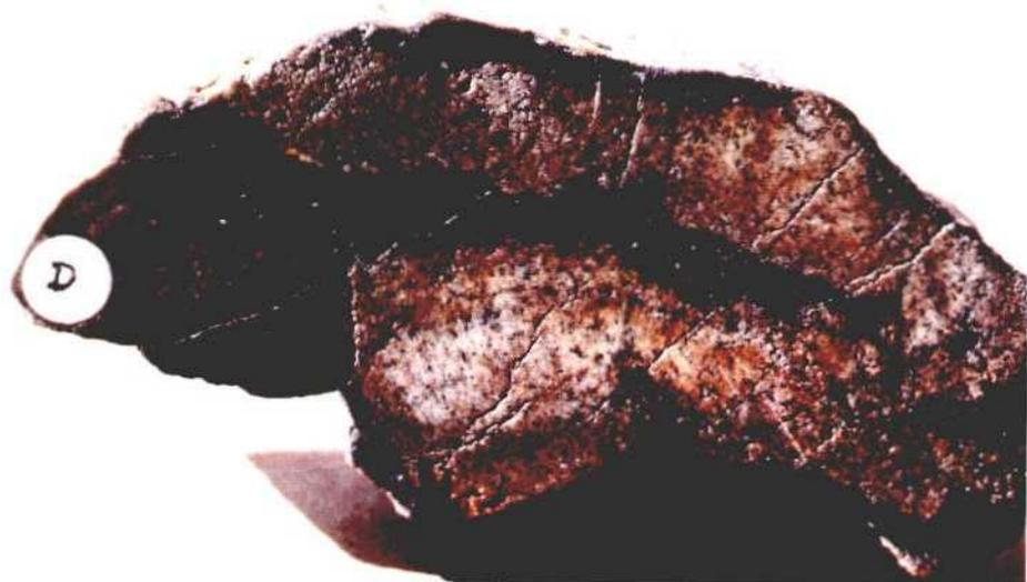
FIGURA 12.10 Y 11- MINA ALEGRIA, MORILLE. LOS NIVELES DE SCHEELITA INTERESTRATIFICADOS EN LOS ESQUISTOS FUERON SUCESIVAMENTE BOUDINADOS Y REPLEGADOS DURANTE LA SEGUNDA Y TERCERA FASES DE DEFORMACION. ESTOS NIVELES ESTÁN RODEADOS POR UN BORDE OSCURO FORMADO POR RUTILO, TURMALINA, CIRCON Y APATITO, LOS QUE FUERON DESPLAZADOS HACIA LOS BORDES AL RECRISTALIZAR LA SCHEELITA.
