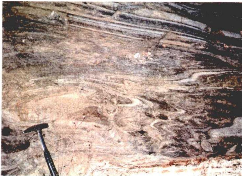
FIGURA 12.2- MINA ALEGRIA. PLIEGUES DE SEGUNDA FASE, DE PLANO AXIAL SUBHORIZONTAL, EN LOS CLORITOESQISTOS DE LA SERIE DE MORILLE.
