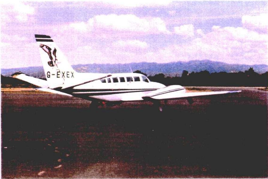
Foto 10 - Avião CESSNA 404, com magnetómetro de reboque C.E.N.G. MRM 360
